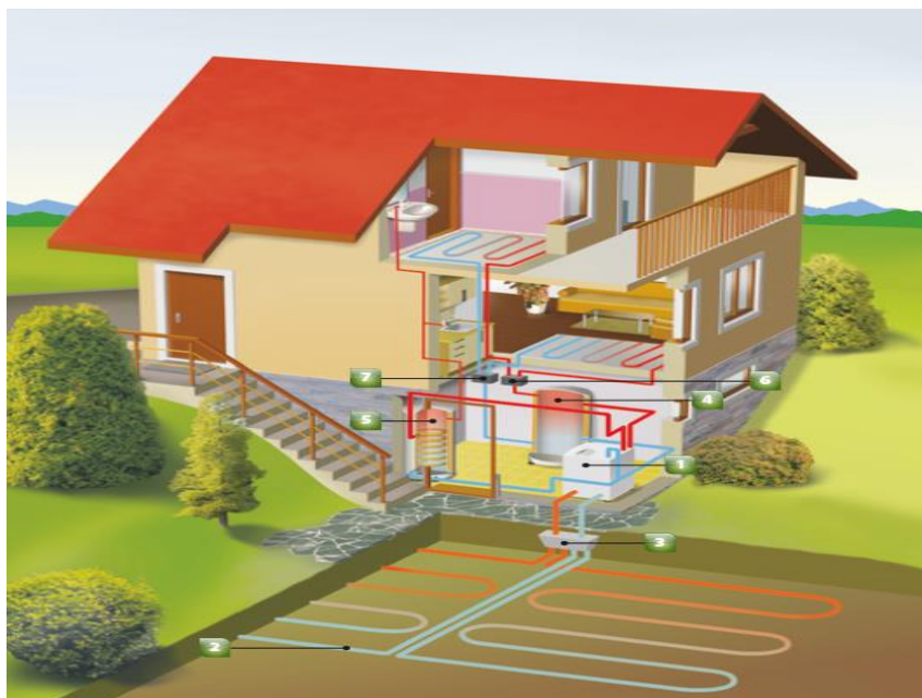
Obrázok 4 Princíp zapojenia čerpadla s plošným zemným kolektorom
