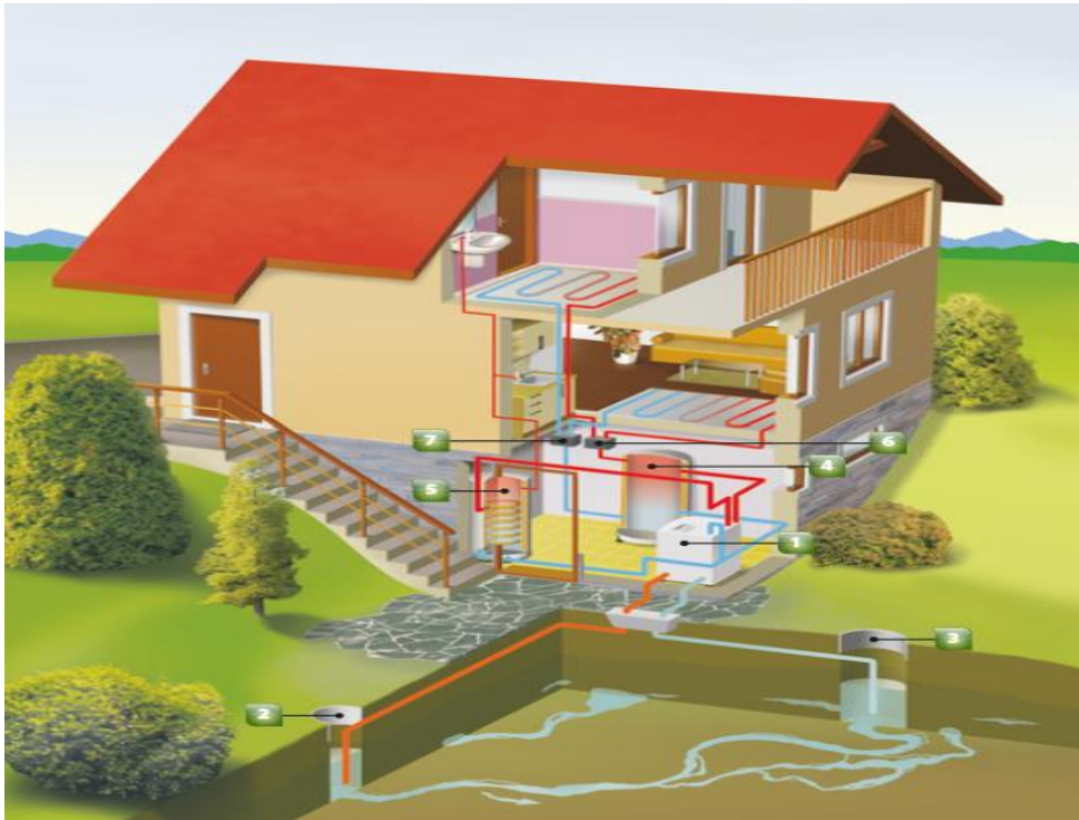
Obrázok 6 Princíp zapojenia čerpadla voda/voda
