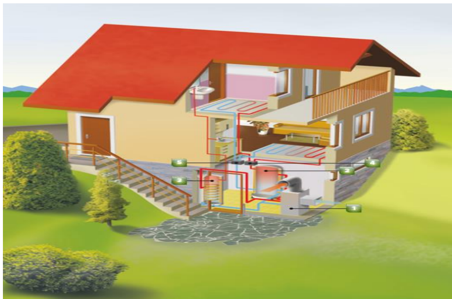
Obrázok 3 Princíp zapojenia čerpadla vzduch/ voda
